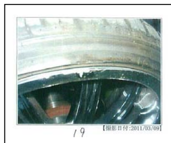
④ 乙車損傷部 3 別事故起因 金属同士の接触痕乙車に無
