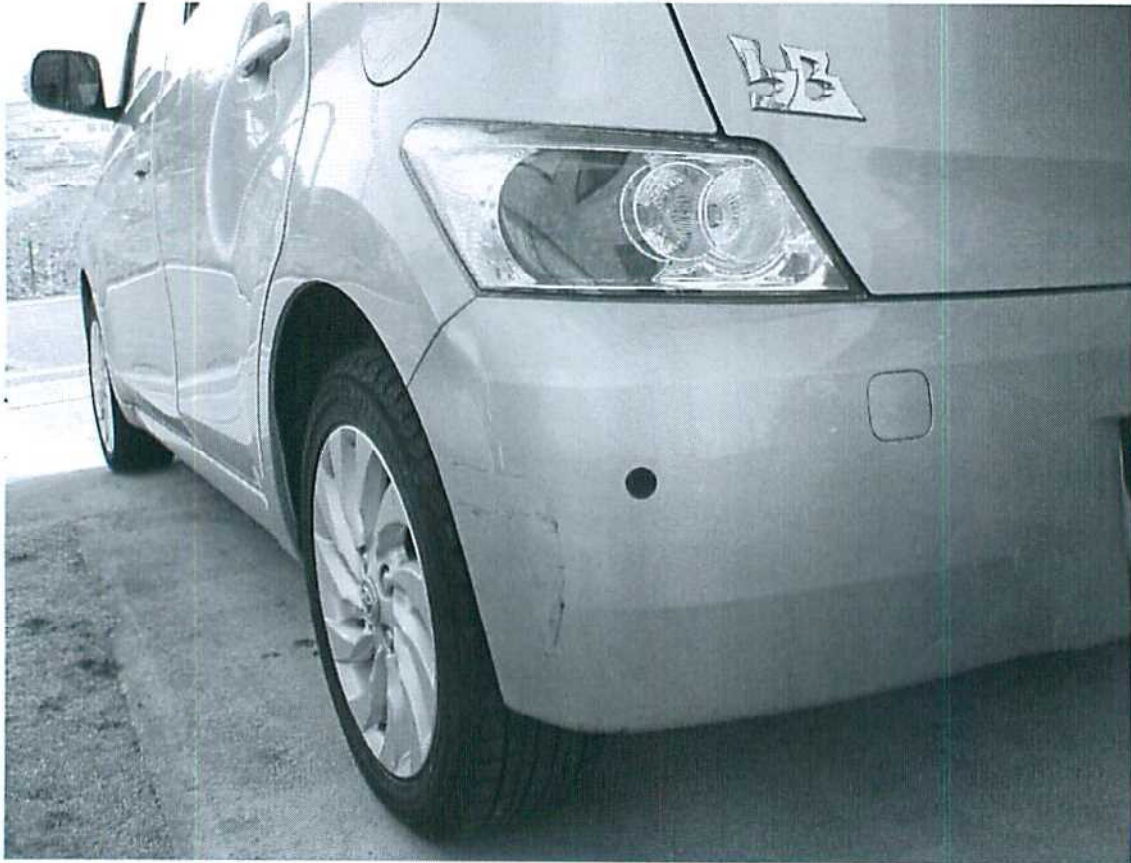
写真 22-1 乙車 損傷部 (乙車タイヤ部分に甲車バンパー先端の部分接触有)
